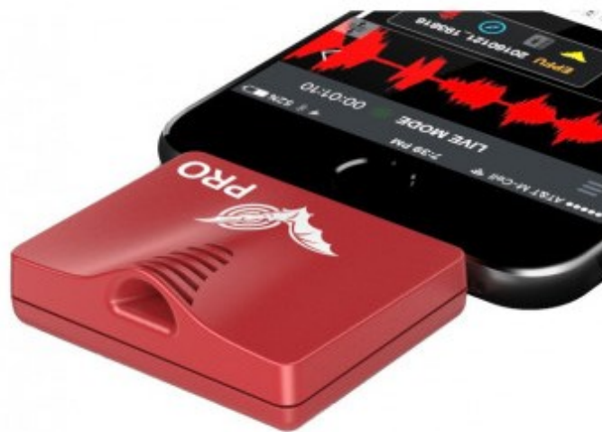
Figura 3.1 – Wildlife Acoustics Echometer Touch 2 PRO collegato a dispositivo mobile.
